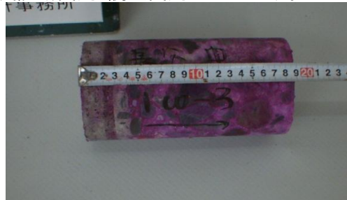
構造体の中性化試験
